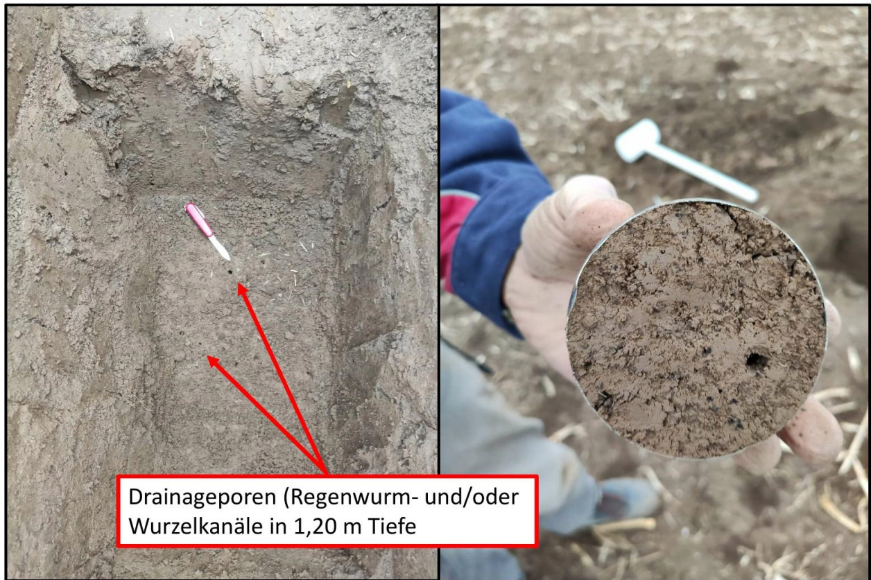
Abbildung 4: Drainageporen (Regenwurm- und/oder Wurzelkanäle) bei dem mit der Bohrung B 2/21 korrespondierenden Bodenprofil im Bauabschnitt BA-A
