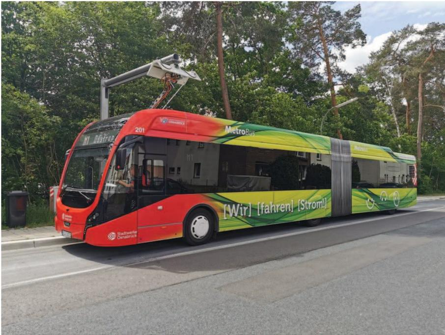
Abbildung 9: Batterieelektrischer Bus mit Gelegenheitsladung an der Endhaltestelle (Osnabrück)
