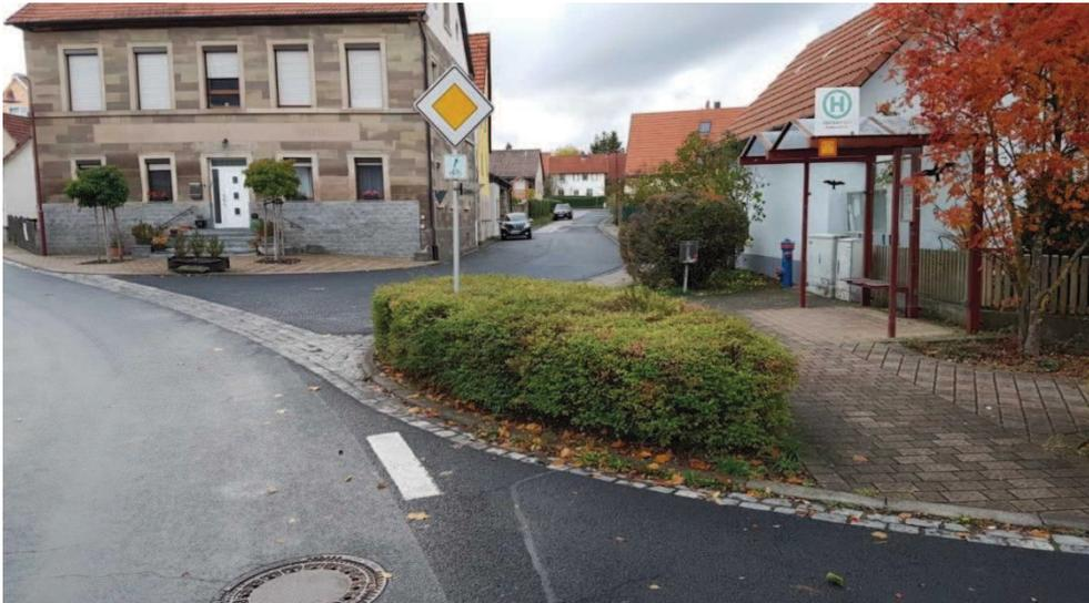
Abbildung 22: Oberlauringen Raiffeisenbank: Eine relativ aufwendige Haltestelle mit Fahrgastunterstand, die jedoch aufgrund ihrer Lage in einer Kurve nicht optimal angefahren werden kann. (Quelle: Haltestellenkataster Landkreis Schweinfurt)
